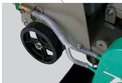
● Przewody z wodą do dwustronnego chłodzenia ostrza
